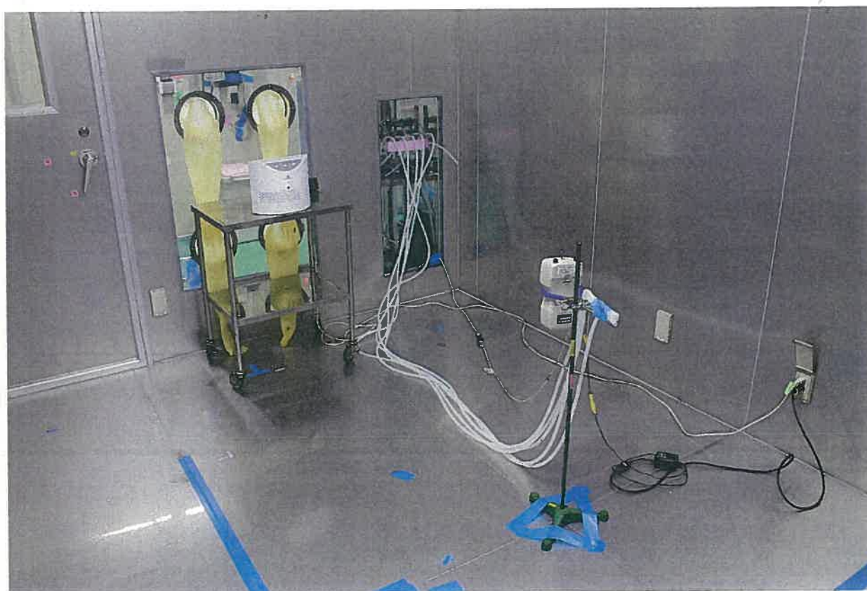
別紙図 b. 試験品試験時の 25 m 3 試験チャンバーの様子
